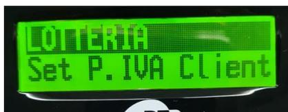
Premere il tasto **TOTALE** per inserire il **CODICE LOTTERIA** tramite i tasti numerici della tastiera oppure tramite apposito lettore di codice a barre certificato DTR
