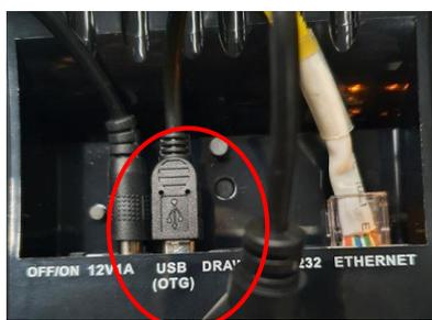
*Per questo tipo di macchina il lettore va collegato tramite il cavetto adattatore USB in dotazione consegnato al momento dell'installazione della macchina e conservato nella busta del LIBRETTO FISCALE*
